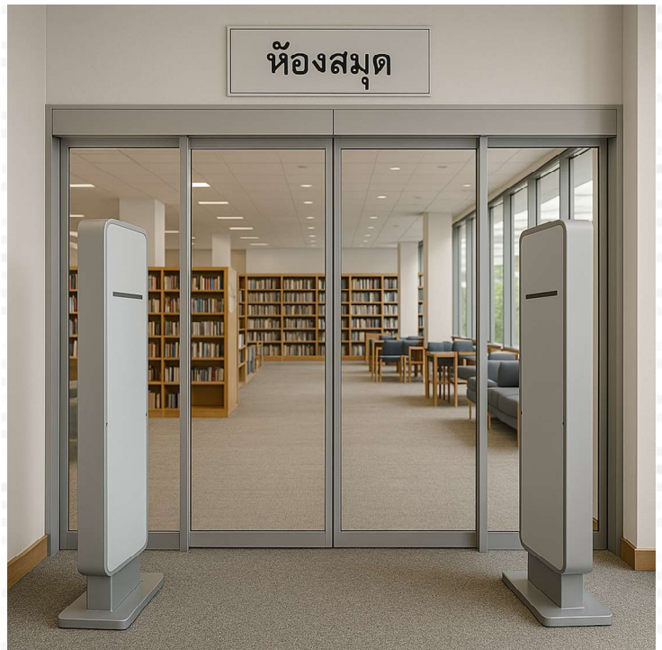
ประตูทางเข้าห้องสมุดติดตั้งระบบ RFID Gate สำหรับตรวจสอบการยืม-คืนหนังสือโดยอัตโนมัติ เพื่อความปลอดภัยและป้องกันหนังสือสูญหายอย่างมีประสิทธิภาพ
